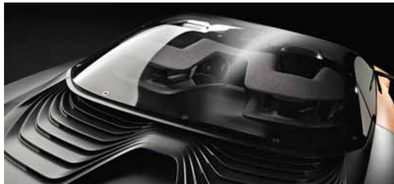
Der gewölbte Dachhimmel gibt den Blick frei auf die Karbonstruktur.
